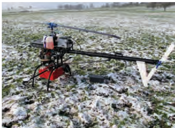
Plnoautomatická bezpilotná helikoptéra s laserovým skenerom
